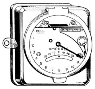
Fig. 304. Delco-Light Ampere-Hour Meter
