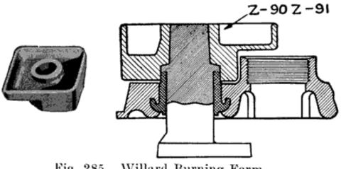
Fig. 285. Willard Burning Form Z-90, Z-91, and How it Is Used
