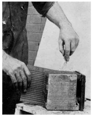
Fig. 225. Inserting Separators
